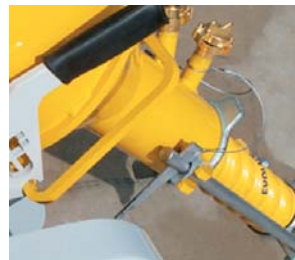
Système de fixation vis-jaquette.
